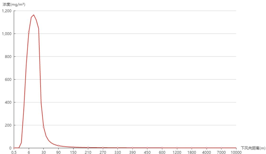
图 5.3-33 最不利气象条件下氟化氢下风向距离浓度曲线图（运输道路泄漏）
